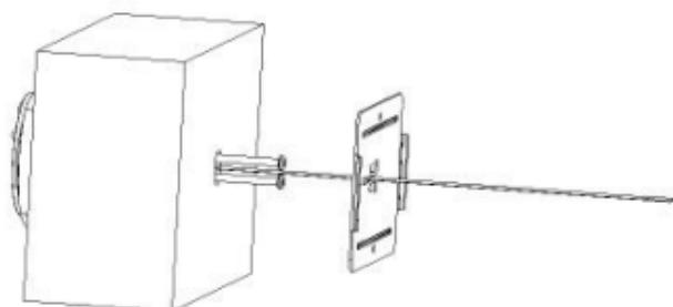
如图平移钢片至螺钉从椭圆形螺钉孔穿出。
